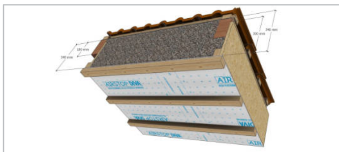
NAVRHOVANÁ A REALIZOVANÁ SKLADBA KONSTRUKCE ZATEPLENÍ
